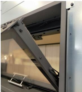
Porte débrayable à basculer pour nettoyage.
