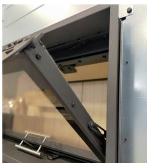
Porte débrayable à basculer pour nettoyage.
