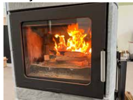
2 - Porte ouverte - Propagation des flammes T0 + 15 min
