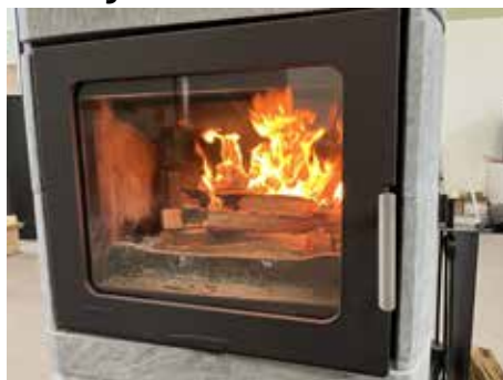
2 - Porte ouverte - Propagation des flammes T0 + 15 min
