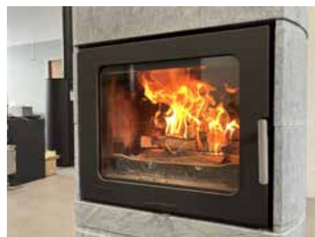
4 - Flammes en post-combustion haute T0 + 22 min
