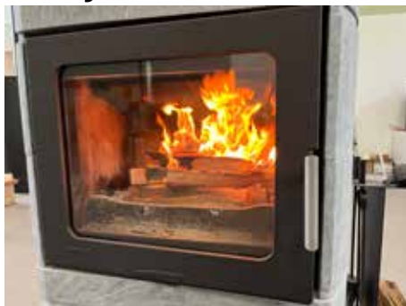
2 - Porte ouverte - Propagation des flammes T0 + 15 min
